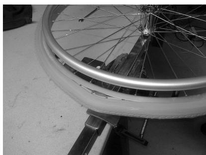
4. girate a mano la ruota fino al punto d'inizio da dove siete partiti girando. Il copertone sarà ora montato sul cerchione
