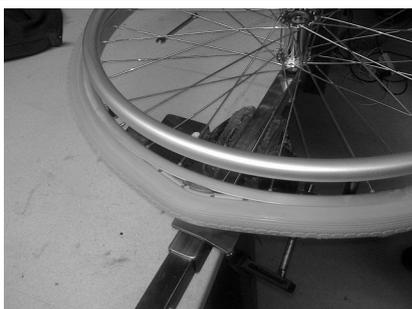
4. Drehen Sie das Rad mit der Hand einmal rundum bis zum Punkt von dem Sie gestartet sind. Der Reifen sollte nun montiert sein.
