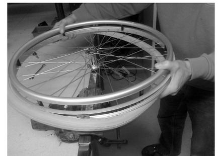
3. Setzen Sie den PU-Reifen auf die Felge und drücken Sie den Reifen so weit wie möglich in die Felge. Achten Sie darauf dass die senkrechte Flosse sich zwischen Reifen und Felge befindet.
