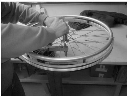
1. Fixieren Sie das Montiergerät im Schraubstock und montieren Sie das Rad mit der Steckachse an der Buchse am Montiergerät.
