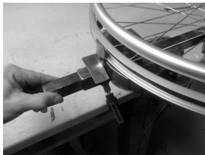
2. Verschieben Sie die Schiene am Montiergerät so dass die senkrechte "Haifischflosse" leicht an der Felge anliegt und blockieren Sie die Schiene mit der Sternschraube.
