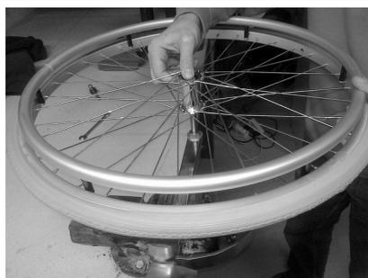
5. Entfernen Sie nun das Rad vom Montiergerät indem Sie es nach oben abziehen und von der Flosse lösen. Dies kann etwas schwergängig sein.
