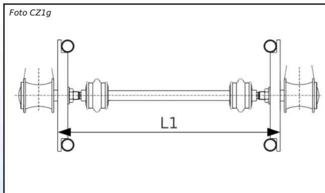
Calcolo della lunghezza dell'asse telescopico ( $L1$  = distanza da parte esterna sx. del tubo telaio a parte esterna dx. del tubo del telaio)
