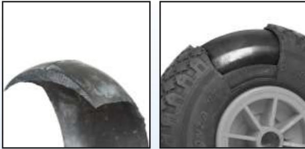
**B11a.** Cinturone Flexel **B11b.** Cinturone (sezione)
