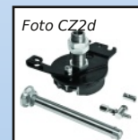
Plato de freno con zapatas y perno
