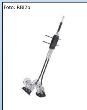
Cables de mono-freno
