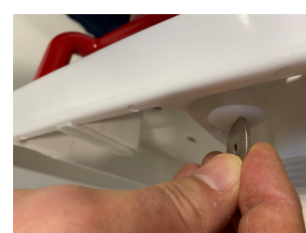
Håndtaget skrues fast med 2 skruer som monteres fra undersiden op i håndtaget
