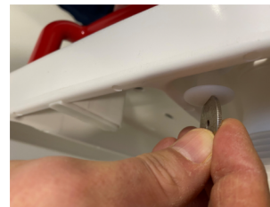
Der Handgriff wird mit 2 Schrauben von der Unterseite befestigt
