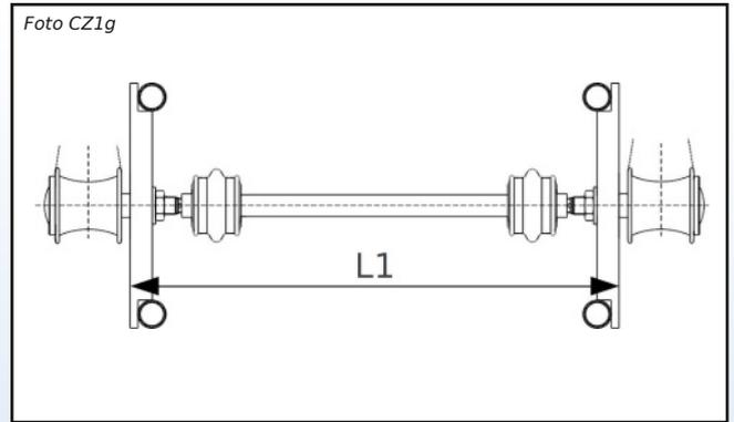
Berechnung der Länge der Teleskopachse (L1) von Rahmenrohr außen links bis Rahmenrohr außen rechts
