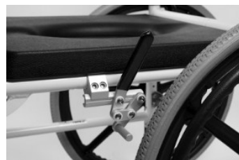
Rys. 4: Montaż hamulców do ramy
