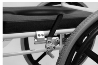
Abb. 4: Befestigung der Bremsen am Rahmen
