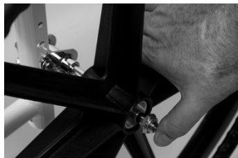
Fig. 2: 24"-hjulet med hurtigudløser
