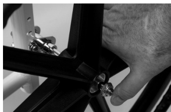
Abb. 2: Das 24" Rad mit Schnellspanner
