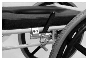
Fig. 4: Montaggio dei freni sul telaio
