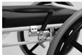
Ill. 4: Montage des freins sur le cadre
