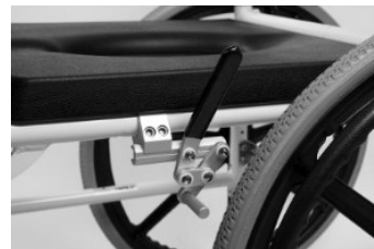
Fig. 4: Montering af bremsen på rammen
