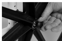
img. 10: applicare il coperchietto
