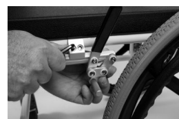
img. 11: fissare il supporto del freno
