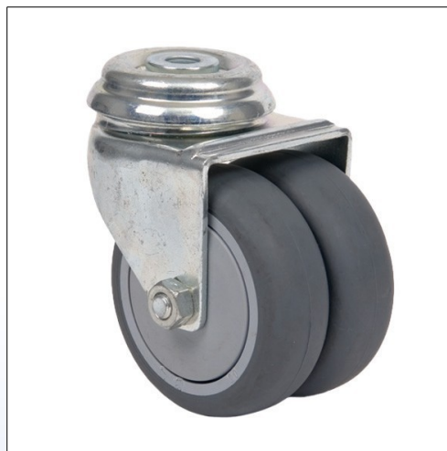
F8. Dobbelt hjul model 2970 uden bremse. Drejeligt hjul med kugleleje for lifte mm.
